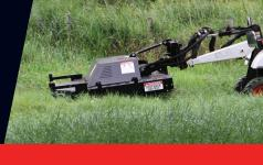
STANDARD RUBBER SHIELDED FRONT **GUARD TO PREVENT FLYING DEBRIS**
